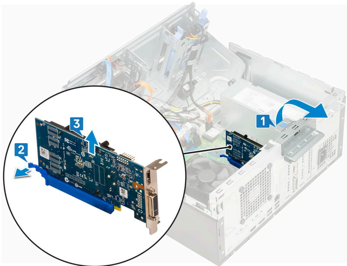
5 Repita los pasos para extraer cualquier tarjeta de expansión PCIe adicional.
